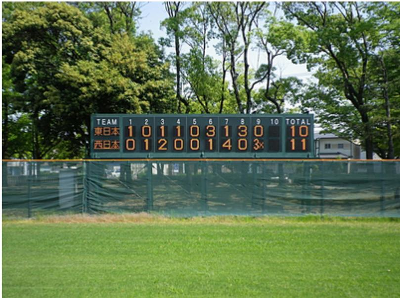
老朽化が目立っていた既設のスコアボードを大幅改修。表示部を磁気反転素子からLED素子に変更。スコアボード及びサブスコアボードの操作は、操作室にある入力装置（ノートPC）から遠隔操作できます。既設のスコアボード筐体部とサブスコアボードを再利用することでコストを抑えつつ、見やすさも使いやすさも向上させることができました。
