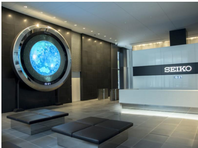
セイコーホールディングス株式会社本社ビルのエントランスロビーに設置された新社屋のシンボル「Seiko Space Eye」。宇宙と時を結ぶ窓の表現を取り入れ、瞳のような円形スクリーンから名付けられました。直径2.8mの円形スクリーンに約3mmピッチの高精細なLED素子（3 in 1フルカラー）を採用し、宝石のような質感と立体感を実現。豊かな自然と生命を育む「水の地球」と、人類が築き上げてきた文明の叡智が輝く「光の地球」が、明暗の表情を時折入れ替えながらゆっくりと回転し悠久の時の流れを表現します。また、デジタルサイネージによる世界時計として、世界全40タイムゾーン、計77都市の現在時刻を表示。毎正時には、約1分間の報時デモンストレーション…
