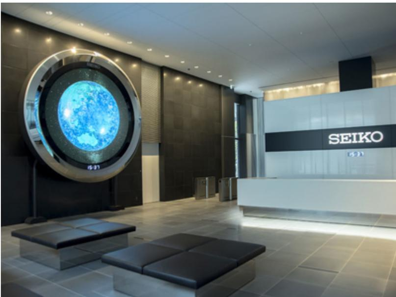
セイコーホールディングス株式会社本社ビルのエントランスロビーに設置された新社屋のシンボル「Seiko Space Eye」。宇宙と時を結ぶ窓の表現を取り入れ、瞳のような円形スクリーンから名付けられました。直径2.8mの円形スクリーンに約3mmピッチの高精細なLED素子（3 in 1フルカラー）を採用し、宝石のような質感と立体感を実現。豊かな自然と生命を育む「水の地球」と、人類が築き上げてきた文明の叡智が輝く「光の地球」が、明暗の表情を時折入れ替えながらゆったりと回転し悠久の時の流れを表現します。また、デジタルサイネージによる世界時計として、世界全40タイムゾーン、計77都市の現在時刻を表示。毎正時には、約1分間の報時デモンストレーション…
