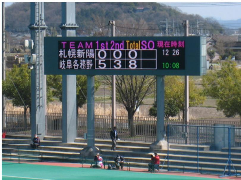
【外形寸法】 W11,060 × H2,605mm (架台除く)
