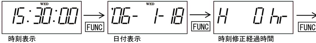
時刻修正経過時間は、電波（Rタイプ）・長波受信器（オプション）・外部同期いずれかの方法で最後に時刻修正を行ってからの経過時間を表示します。
